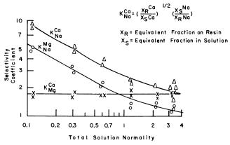
Figure 9. Ion exchange equilibria  $Ca^{**}\text{--}Mg^{**}\text{--}Na^{*}\text{--}Dowex 50W$
